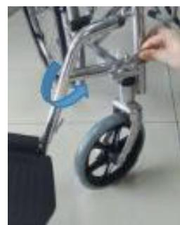
Zoals aangegeven in de bovenstaande figuur, maakt u de draaiing naar binnen, waarna de afneembare voetsteun wordt vergrendeld nadat u een klikgeluid hebt gehoord.
