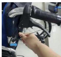
Jak pokazano na rysunku po lewej stronie, naciśnij przycisk na zewnątrz, aby zamocować uchwyt (jak pokazano na rysunku po prawej stronie).
