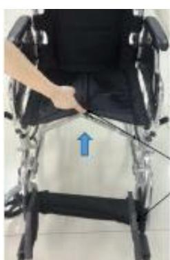
Ripiegamento: come mostrato nella figura a sinistra, piegare prima i due pedali laterali verso l'esterno, quindi sollevare con le mani la parte centrale del cuscino del sedile per piegare l'intera carrozzina.
