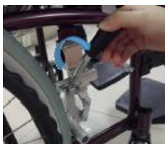
Wie in der Abbildung links dargestellt, wird die Bremse blockiert, nachdem Sie den Bremsgriff nach vorne gedrückt haben (in Pfeilrichtung, wie abgebildet). Die Bremse wird gelöst, nachdem die Betätigung in umgekehrter Richtung erfolgt ist.
