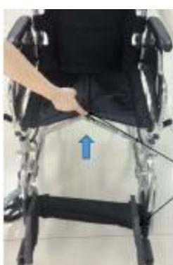
Inklappen: Zoals op de afbeelding links te zien is, klapt u eerst de twee zijpedalen naar buiten, daarna tilt u met uw handen het middelste deel van het zitkussen op om de hele rolstoel in te klappen.
