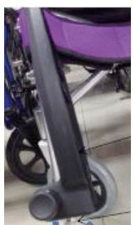
Como mostra a figura à esquerda, por favor pegue no pedal e aplique a chave de suporte para soltar o parafuso, depois ajuste-o à altura apropriada de acordo com a procura dos utilizadores.
