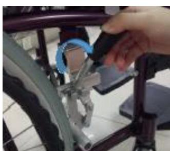
Como mostra a figura à esquerda, o travão bloqueará depois de premir a manete do travão para a frente (a direcção da seta como mostrado). O travão será libertado após pressionar a operação no sentido inverso.
