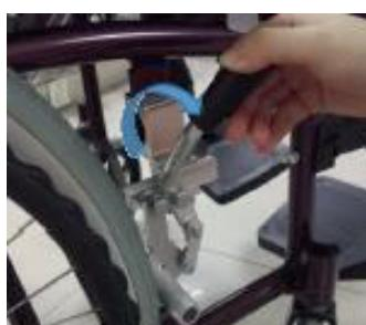
Como se muestra en la figura de la izquierda, el freno se bloqueará después de presionar el mango del freno hacia adelante (la dirección de la flecha como se muestra). El freno se liberará después de presionar la operación en la dirección inversa.
