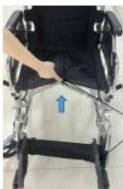
Plegado: Como se muestra en la figura de la izquierda, en primer lugar, pliegue los dos pedales laterales hacia fuera, luego, levante la parte central del cojín del asiento con las manos para plegar toda la silla de ruedas.
