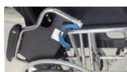
Drücken Sie den Handlauf, wie in der Abbildung oben gezeigt, leicht in Pfeilrichtung. Wenn ein Klicken zu hören ist, ist der Handlauf verriegelt und fixiert.
