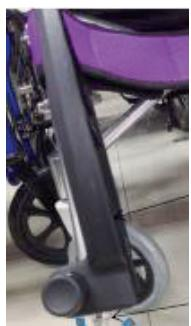
Como se muestra en la figura de la izquierda, por favor tome el pedal y aplique la llave de apoyo para liberar el tornillo, luego, ajústelo a la altura adecuada de acuerdo a la demanda de los usuarios. Suelte el tornillo según la dirección de la flecha (herramientas estándar).
