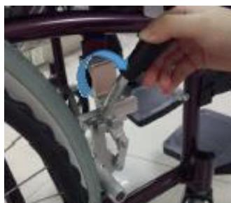
Som vist på figuren til venstre låses bremsen, når du trykker bremsegrebet fremad (i pilens retning som vist). Bremsen frigøres, når du trykker på betjeningen i den modsatte retning.
