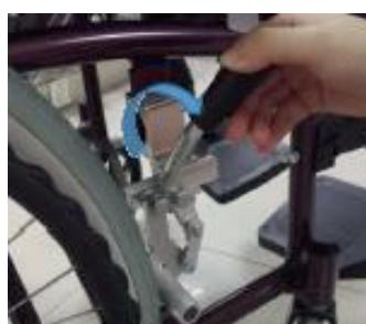
Come mostrato nella figura a sinistra, il freno si blocca dopo aver premuto la maniglia del freno in avanti (nella direzione della freccia). Il freno verrà rilasciato dopo aver premuto l'operazione in senso inverso.
