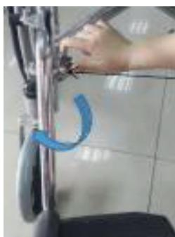
Jak pokazano na rysunku po lewej stronie, pociągnij płytę blokady sprężynowej w kierunku korpusu, a następnie obróć zdejmowany wspornik stopy (kierunek jak pokazano), aby usunąć ruchome wsporniki stopy.
