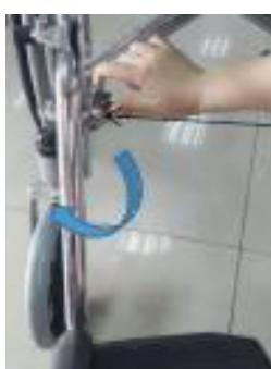
Como mostra a figura à esquerda, puxar a placa de bloqueio da mola em direcção ao corpo, depois rodar o suporte de pé amovível (direcção como mostrado) para remover os suportes de pé móveis.
