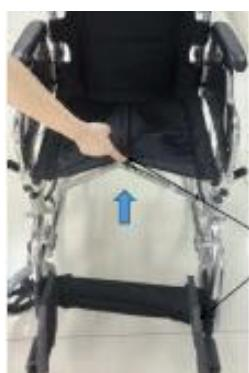
Falten: Wie in der Abbildung links gezeigt, klappen Sie zuerst die beiden seitlichen Pedale nach außen und heben Sie dann den mittleren Teil des Sitzkissens mit den Händen an, um den gesamten Rollstuhl zu falten.
