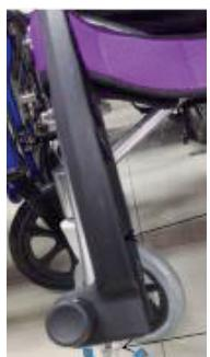
Som visas i figuren till vänster ska du ta pedalen och använda stödnyckeln för att frigöra skruven och sedan justera den till lämplig höjd enligt användarnas behov.
