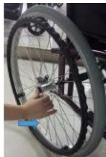
Jak pokazano na rysunku po lewej stronie, przednie koło zostanie zdjęte po naciśnięciu rękami czarnego przycisku znajdującego się na środku koła, podobnie tylne koło można zamontować po naciśnięciu i wsunięciu przycisku.
