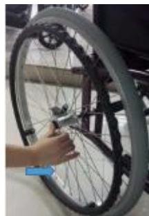
Wie in der Abbildung links zu sehen ist, wird das Vorderrad nach Drücken des schwarzen Knopfes in der Mitte des Rades mit den Händen herausgezogen, ebenso kann das Hinterrad nach Drücken und Einschieben des Knopfes eingebaut werden.
