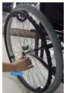
Comme le montre la figure de gauche, la roue avant sera retirée après avoir appuyé avec les mains sur le bouton noir situé au centre de la roue. De même, la roue arrière peut être installée après avoir appuyé sur le bouton et l'avoir enfoncé.
