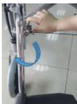
Comme indiqué sur la figure de gauche, tirez la plaque de verrouillage à ressort vers le corps, puis tournez le support de pied amovible (dans le sens indiqué) pour retirer les supports de pied mobiles.
