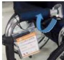
1. Fassen Sie den Handlauf fest an und schieben Sie ihn in Pfeilrichtung (wie in der Abbildung oben dargestellt).
