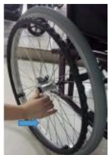
Como mostra a figura à esquerda, a roda dianteira será removida após premir o botão preto no centro da roda com as mãos, do mesmo modo, a roda traseira pode ser instalada quando o botão é premido e premido.
