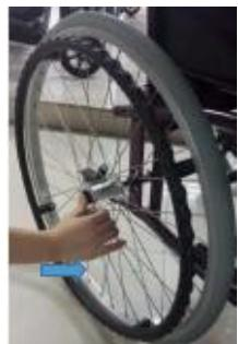
Zoals op de afbeelding links te zien is, wordt het voorwiel verwijderd nadat u met uw handen op de zwarte knop in het midden van het wiel hebt gedrukt.
