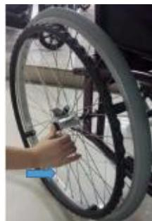
Som visas i figuren till vänster tas framhjulet bort när du trycker på den svarta knappen i mitten av hjulet med händerna, på samma sätt kan bakhjulet monteras när du trycker på knappen och trycker in den.
