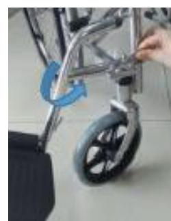
Como se muestra en la figura anterior, por favor haga la rotación hacia el interior, entonces, el soporte de pie desmontable se bloqueará después de escuchar el sonido de clic.
