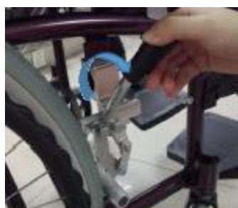
Zoals in de figuur links te zien is, zal de rem vergrendelen nadat de remhendel naar voren is gedrukt (de richting van de pijl zoals afgebeeld). De rem wordt gelost na het indrukken van de bediening in omgekeerde richting.
