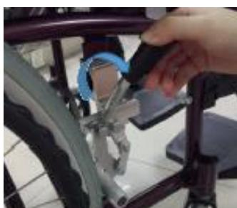
Jak pokazano na rysunku po lewej stronie, hamulec zablokuje się po naciśnięciu klamki hamulca do przodu (kierunek strzałki jak na rysunku). Hamulec zostanie zwolniony po naciśnięciu operacji w kierunku odwrotnym.
