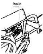
Stellen Sie sicher, dass die Bremsen angezogen sind, bevor Sie in den Rollstuhl ein- oder aussteigen.
